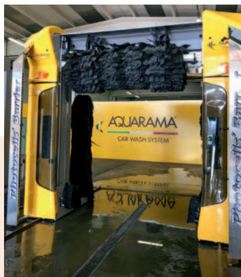
Un impianto di lavaggio per automobili di Aquarama, dove i cilindri Aignep della 'Serie X' consentono movimenti accurati delle spazzole di lavaggio e della lama di asciugatura
